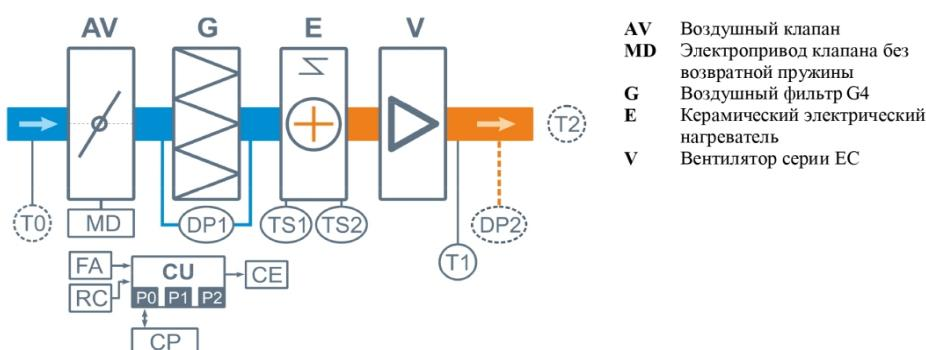
На входе вентустановок 550 Lux и 550 Lux SB можно установить два фильтра: после стандартного фильтра грубой очистки G4 есть дополнительные салазки для установки компактного фильтра тонкой очистки F7 или угольно-пылевого F7
