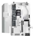
Электронный блок предназначен для управления трехходовым клапаном регулирования производительности и вентилятором фанкойла в соответствие с сигналом, поступающим от электронного пульта управления RCL или пульта mBMS.
